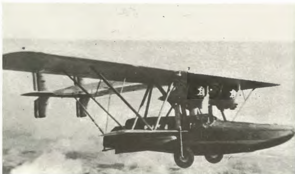
6.—El Sikorsky RS-1. en esta fotografía con el tren despegado.
