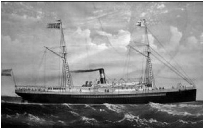
El Argonauta era un buque ya de casco de hierro muy sólido, gracioso de líneas y propulsión por hélice, con dos cubiertas corridas.
