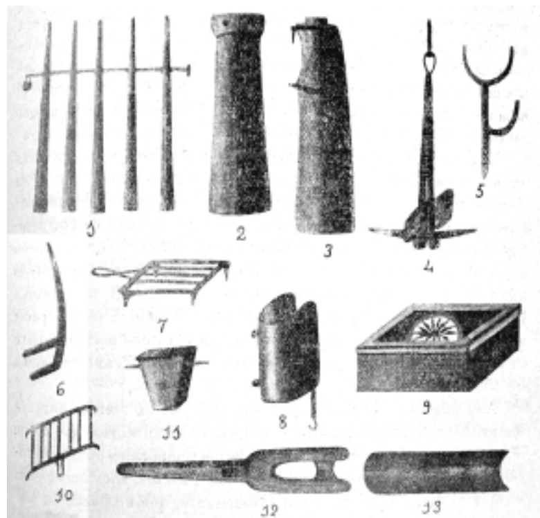
Provincia de Santander. — Enseres curiosos de las embarcaciones de pesca: 1, remos atravesados con una barra de hierro, cerrada con un candado, para evitar que los roben de las embarcaciones; 2, orza para colocar al costado de sotavento cuando se navega á la vela con viento fresco; 3, timón de las traineras; 4, potada, especie de arpeo con dos palos y una piedra, sirve para fondar en donde hay roca por si hay que picar el cabo que lo sujeta y perderlo, y así se pierde menos que si fuese el arpeo; 5, horquilla de hierro doble para colocar en el costado de las lanchas de bonito y descansar en ellas las alas ó varas por las cuales pasan los aparejos de pesca; la baja sirve para barlovento y la alta para sotavento; 6, aguja del timón; 7 y 10, clases de parrillas usadas en las lanchas del bonito para asar la pesca; 8, guarda aguja ó defensa que se coloca en la aguja, á fin de que ésta no se cierre con los golpes ó embestidas que reciben unas de otras en los puertos que no son muy seguros; 9, aguja ó compás de gobernar, dentro de su caja; 11, cuña para calzar el palo mayor una vez izado, á fin de que no se mueva; 12, gavieta para colocarlo en la roda de proa y pasar por él el cabo del arpeo y llevarlo; la soldana de madera que tiene es muy gruesa y fuerte; 13, tariesta, trozo de madera hueco por dentro, que se coloca en la borda y corren por él los aparejos sin romperse.
