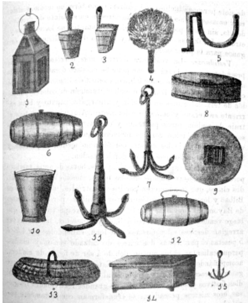
Provincia de Santander. — Enseres curiosos de las embarcaciones de pesca: 1, farol para las lanchas de merluza, besugo y boniteras, de tres cristales blancos, color natural; 2 y 3, tamartes ó baldes de madera para achicar el agua en embarcaciones de bajura; 4, soplillo para encender la lumbre en las lanchas de bonito; 5, aro para colocar la palamenta al limpiar el barco; 6 y 12, barriles de embarcaciones de altura y bajura, para agua; 7 y 11, arpiar el barco; 8, cocina de las lanchas; 9, tapa de la cocina; 10, cubo para achicar el agua de las lanchas boniteras; 13 y 14, cesta y arquilla para bajura y altura; la cesta es la que llevan al mar cada pescador de bajura y la arquilla los de altura; 15, grampín para atracar los barcos menores al muelle ó escalas.
