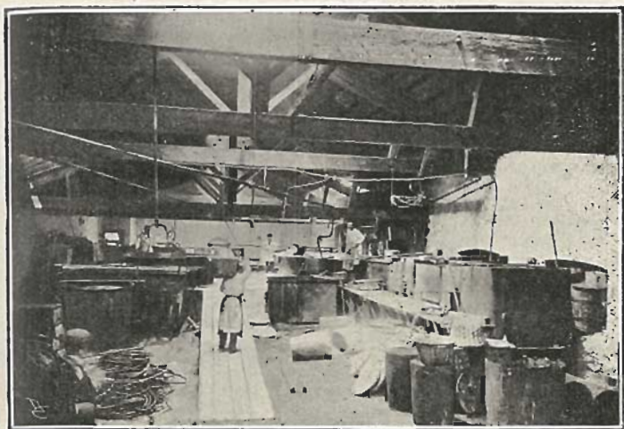
Una de las naves de Calderas de cobre que puede contener 20.000 kilogramos de jabón.
