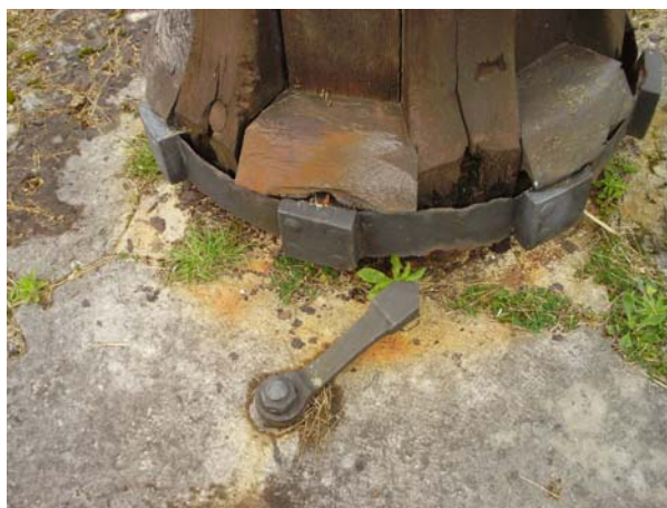
Uno de los frenos para evitar el retroceso del cabrestante.
